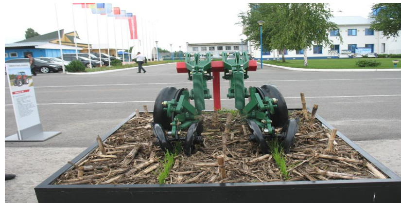
Brăzdar combinat cu cuțite de tip disc riflat și daltă.
