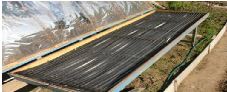
Рис.1. Общий вид СНВ с трубчатым абсорбером
