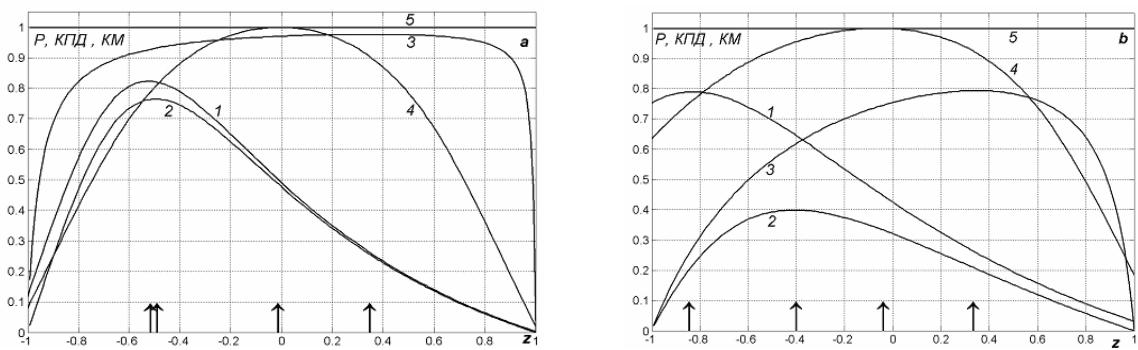
Рис. 4.4. Зависимость генерируемой и передаваемой мощности, КПД и КМ источника и приемника от сопротивления нагрузки  $R_s$  при  $l = 0.0516$ ;  $R = 0.48(a)$ ;  $4.8(b)$ ;  $G = R/5$ ;  $Z_s = R_s$ , где 1 –  $P_1$ ; 2 –  $P_2$ ; 3 –  $\eta$ ; 4 –  $\cos\varphi_1$ ; 5 –  $\cos\varphi_2$
