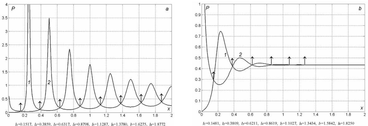
Рис. 4.2. Зависимость от длины линии  $x$  мощности генератора  $P$  в режиме ХХ (1) и КЗ (2) при  $R = 0.48$  (a);  $R = 4.8$  (b);  $G = R/5$ .
