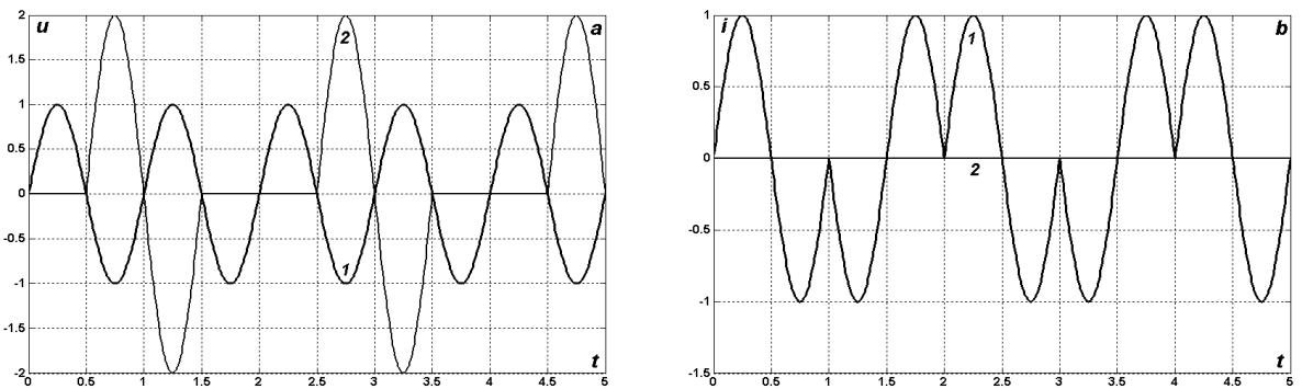
Рис. 4.5. Динамика изменения напряжения (*a*) и тока (*b*) в начале и конце линии (кривые 1;2) при  $l = 1/2$ ;  $R = G = 0$ ;  $R_s = \infty$  (XX).
