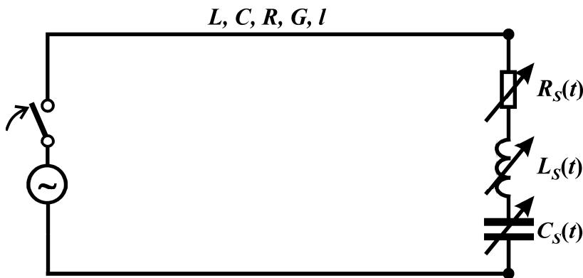
Рис 4.1. Линия переменного напряжения с  $RLC$ –нагрузкой на конце.
