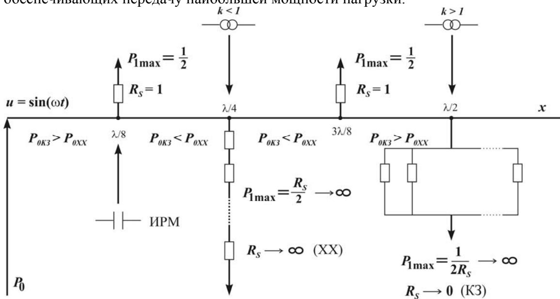
Рис.4.3. Особые точки длинной линии и рекомендуемые схемы включения компенсирующих устройств, трансформаторов и нагрузок
