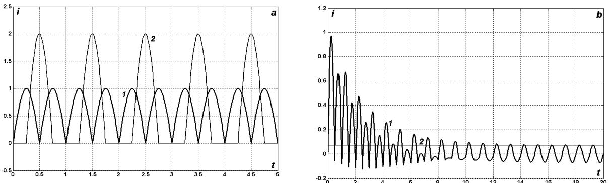
Рис.4.6. Динамика изменения тока в начале и конце линии (кривые 1;2) при  $l = 1/4$ ;  $R_s = 0$  (КЗ);  $R = G = 0$  (*a*);  $R = 5G = 0.48$  (*b*). Зависимость (кривая 2 на рис.4.6*b*) получено методом комплексных амплитуд
