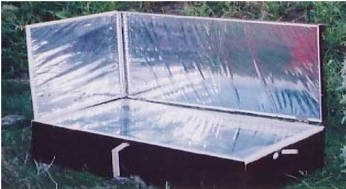
Рис.2 Солнечный нагреватель воды ёмкостного типа с полимерным абсорбером и плоскими рефлекторами
